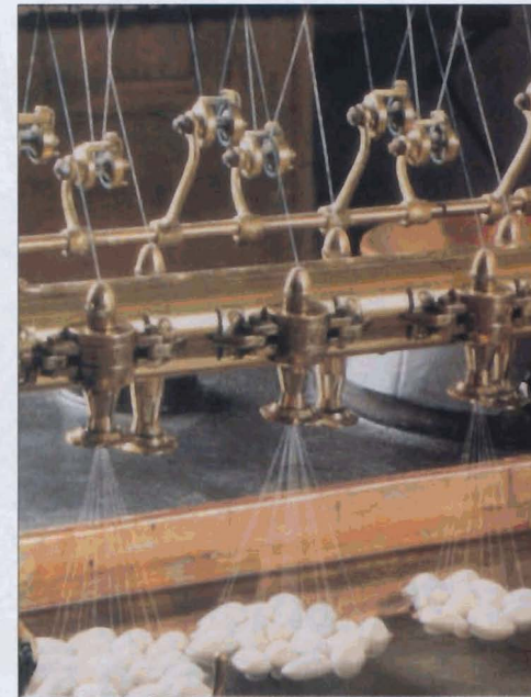
Filature : extraction de la soie du cocon
