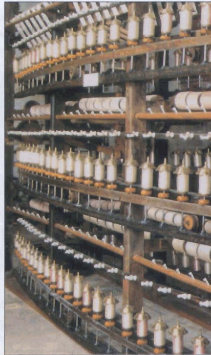
Moulinage : opération de torsion du fil pour en augmenter la résistance
